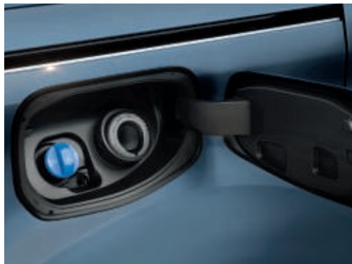
Sistem za preprečevanje dolivanja napačnega goriva Ford Easy Fuel (Serijska oprema)
